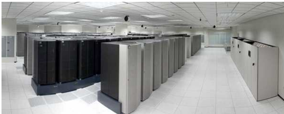
Slika 10: ASCI White – prvi superračunar sa brzinom većom od 10Tflops-a
